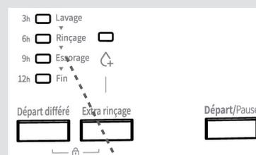
Pour exécuter la fonction de départ différé, votre machine doit être mise en fonctionnement en appuyant sur le bouton Marche/Veille.
