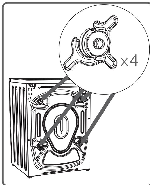
C'est pourquoi il faut dévisser les vis de sécurité de transport en les faisant tourner dans le sens antihoraire à l'aide d'une clé appropriée.
