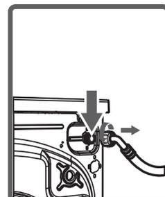
• Un débit d'eau sous une pression de 0,1 à 1 MPa doit permettre un fonctionnement plus eff cace de la machine. (Une pression de 0,1 MPa signif e que plus de 8 L d'eau doivent s'écouler à travers un robinet par minute.)
