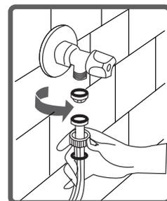
• On veillera à ce que les points de contact ne fuent pas en ouvrant complètement le robinet après avoir effectué les raccordements.de se produire du fait d'une utilisation sauvage.
