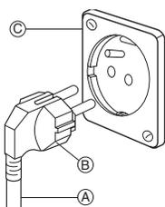
Pour votre sécurité personnelle, ce lave-linge doit être mis à la terre. Celui-ci est équipé d'un cordon d'alimentation A dont la prise B comporte un contact de mise à la terre. Afin de minimiser le risque de choc électrique, la prise du cordon doit être branchée sur une prise murale C de type correspondant. S'il ne dispose pas d'une prise murale appropriée, le client est tenu d'en faire installer une par un électricien qualifié.
